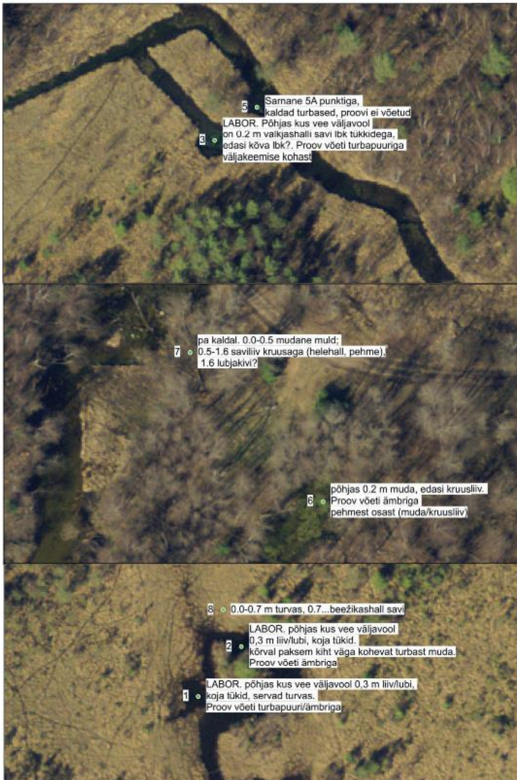
Joonis 10 Puurimise ja proovivõtu skeem 2 Kiigumõisas
